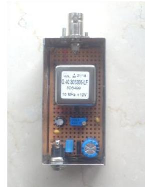
**Figura 4: Característica del oscilador de prueba de 10MHz con ruido de fase muy bajo**
