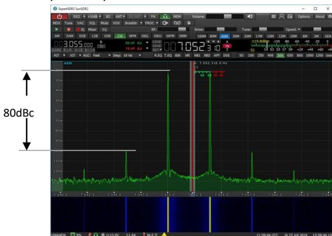
**$P_i=2x-20\text{dBm}$ , Bandpass-Filter On,  $\text{IMD}_3=80\text{dBc}$
