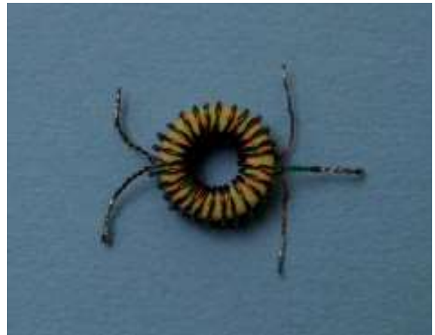
Fig. 28 - Detalles de construcción del transformador T1
